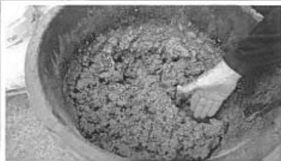
Foto 2: (Der testes for hvornår speciel mørtlen har sin korrekte konsistens.)
